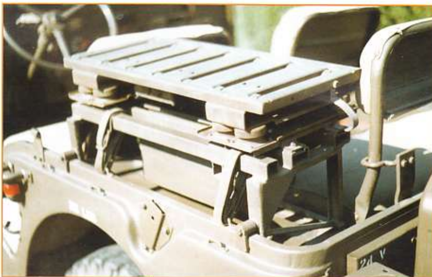
Detailopname van de mounting voor de radio-installatie op de Nekaf jeep
